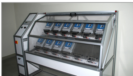
Badanie liczników w testerze izolacji TI-12a
