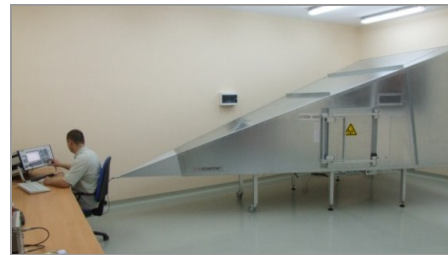
Pomiar zakłóceń radiowych w komorze GTEM 1000
