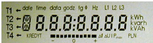
Możliwości prezentacyjne dedykowanego wyświetlacza LCD zastosowanego w liczniku EA4-M
